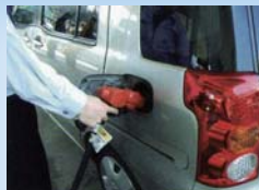
止まるところまで確実に差し込む 給油を開始したら途中で手を放さない
