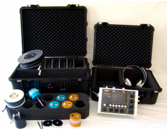
▲ 今回使ったのはこちらの機具 特殊な機械で、地中の振動や音を探知できます。
